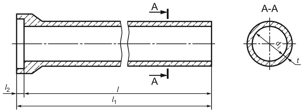
Рисунок А.1 — Общий вид труб типа Т
