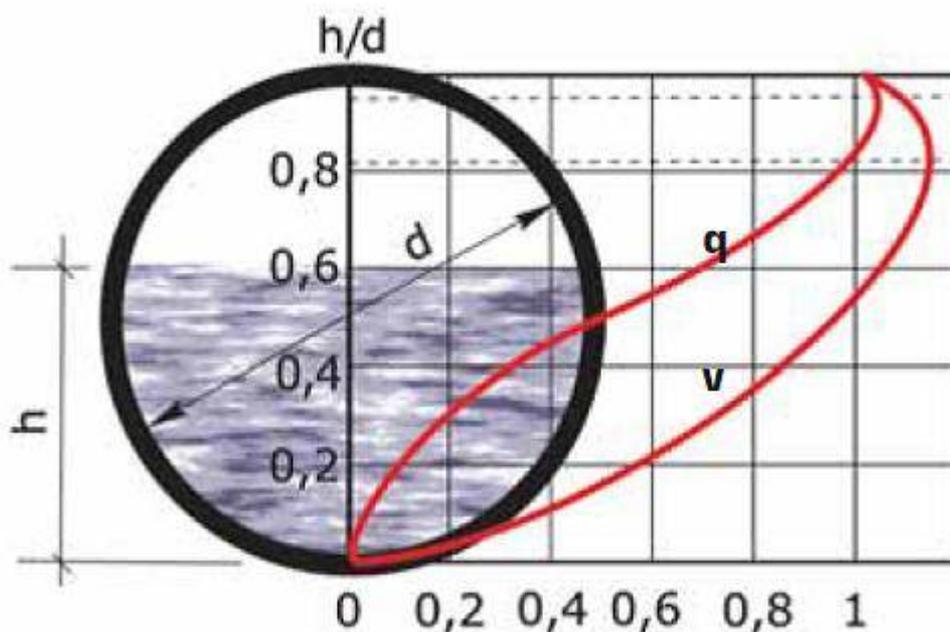
На рисунке приведены кривые изменения скоростей  $v$  и расходов  $q$  в трубах круглого сечения в зависимости от степени их наполнения. По оси ординат отложены степени наполнения  $h/d$ , а по оси абсцисс - соответствующие этим наполнениям скорости  $v$  и расходы  $q$ , выраженные в долях от скорости и расхода при полном наполнении.
