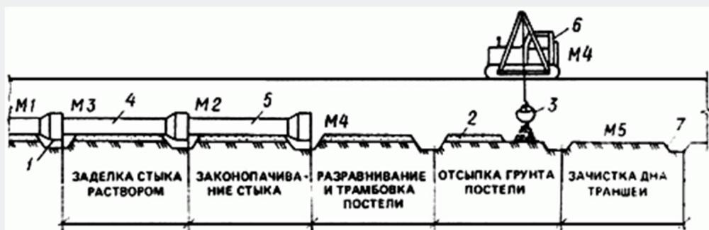
Рис.23. Общая схема размещения механизмов и исполнителей при прокладке трубопровода
